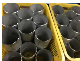
ステンレス用パイプ (開先加工済み)
