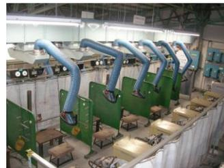
各ブースに排風機設置、電流、電圧計設備各溶接姿勢用治具設置
