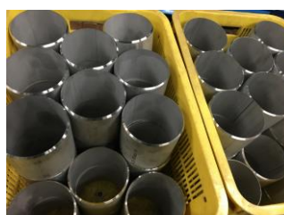
ステンレス用パイプ (開先加工済み)
