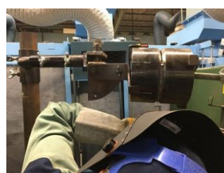
使い勝手の良い治具 水平固定(立向溶接)
