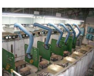
各ブースに排風機設置、電流、電圧計設備
