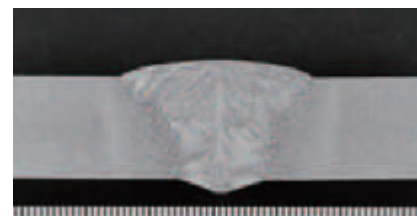
溶接部のマクロ観察例
