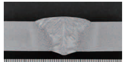
溶接部のマクロ観察例
