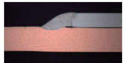
ステンレス鋼と銅におけるレーザブレイジング例
