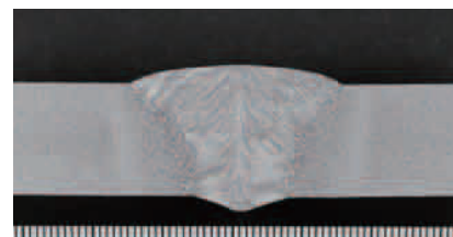
溶接部のマクロ観察例
